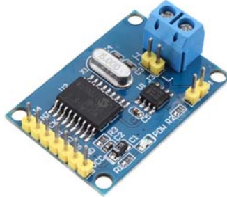
Fig. 6. Prezentarea modului CAN MCP2515.
